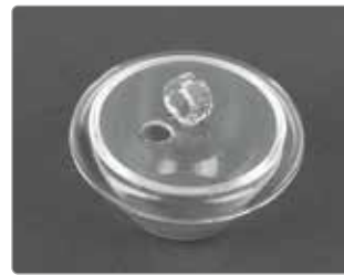
Кварцевый тигель с крышкой (с опциональным отверстием для калибровки)
