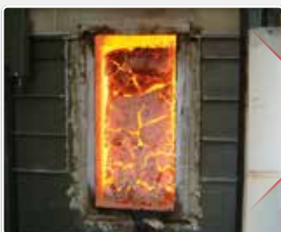
Кокс после 18 часов обработки
