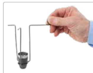
Стандартный проволочный держатель с тиглем и крышкой (VMF/ASTM)
