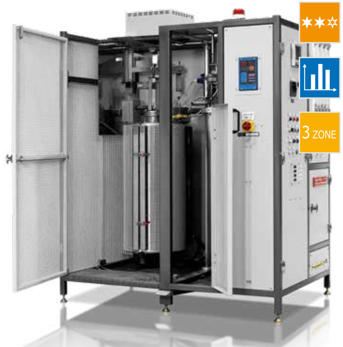
Печь для определения восстановимости железной руды, оснащенная вертикальной рабочей камерой с 3 зонами нагрева и встроенным шкафом управления, расположенным сбоку
