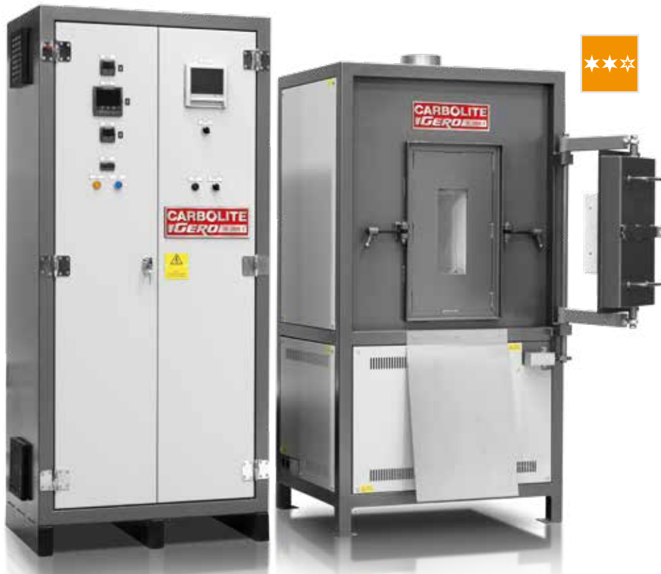
Термошкаф с неподвижной стенкой для определения коксуюмости угля
