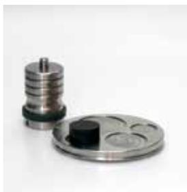
Выравнивающая пластина с образцами
